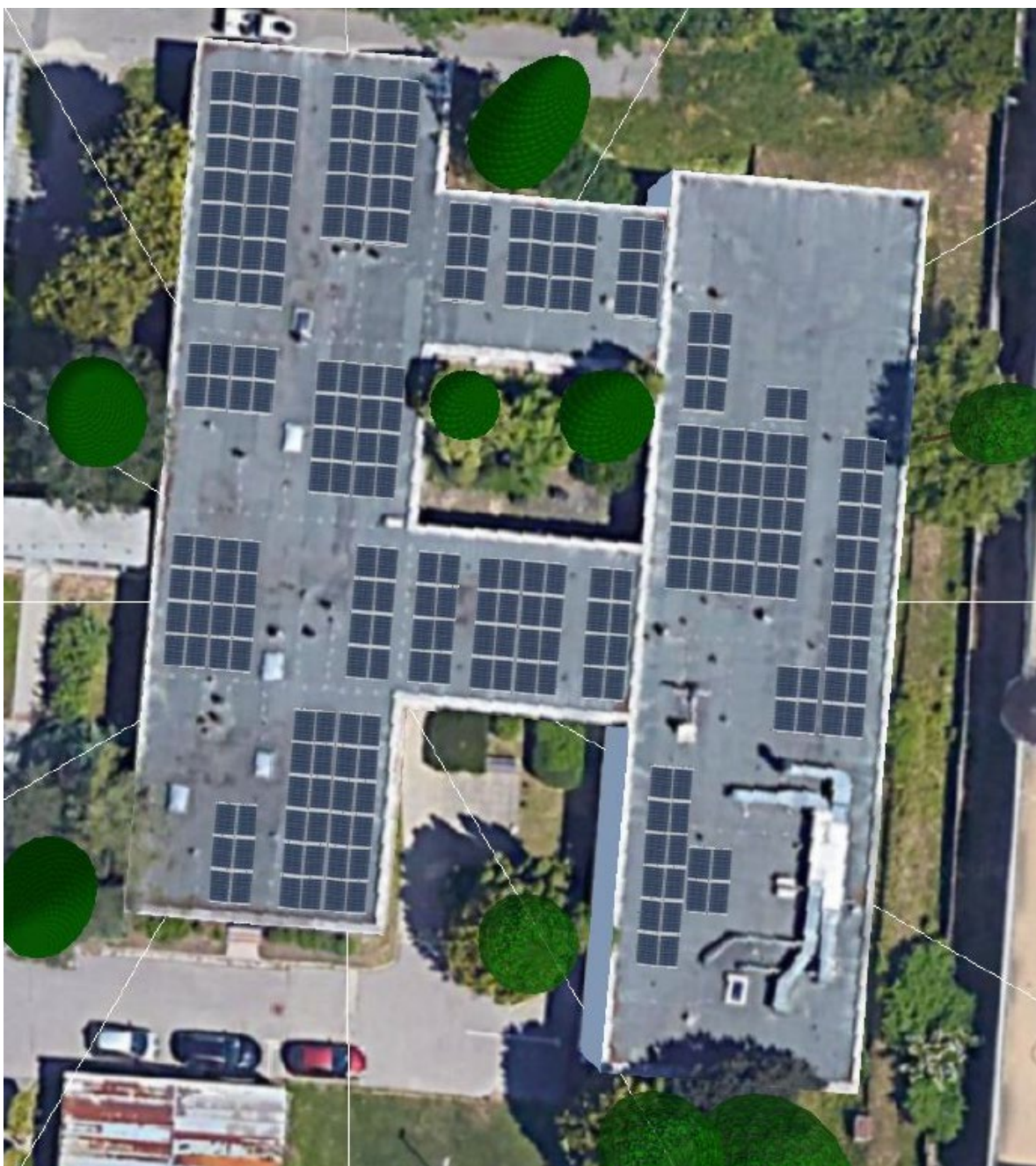
Obrázek 14 Vizualizace instalace FVE o výkonu 99,9 kWp na budově
